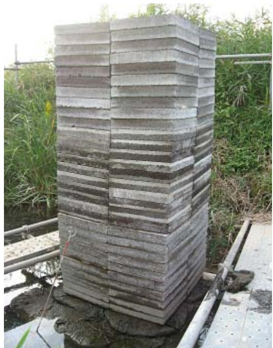
写真-3 沼地載荷試験での土のう積層体上のコンクリート平板の積層状態 (総重量 2.7tf (約 27kN)、80cm×80cm×高さ約 1.9m)
