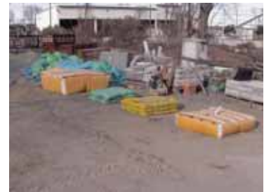
(b) 手前よりLS100、SS90、土のう、LS150 写真-8 D・BOXの振動実験
