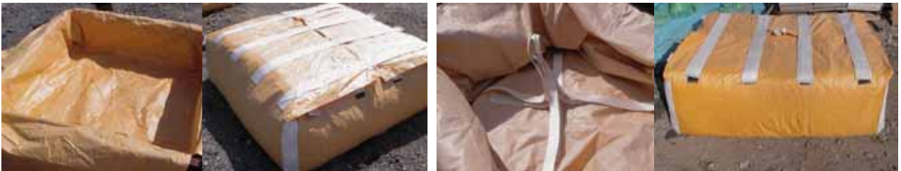
1) トラスバンド無の内部と中詰材投入後の様子 2) トラスバンド有の内部と中詰材投入後の様子
