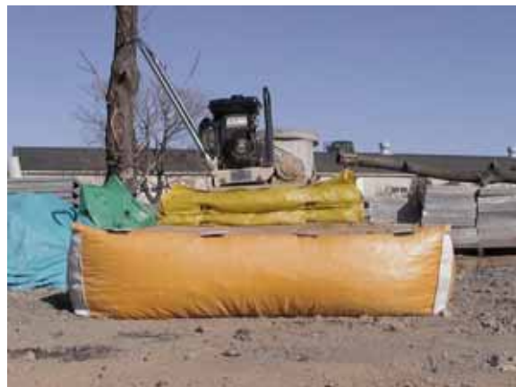
写真 - 11 LS150 の上に SS90 を 2 段積層した場合の振動実験の様子
