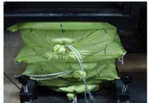
写真-2 土のう積層体6段の繰返しせん断試験の状況
